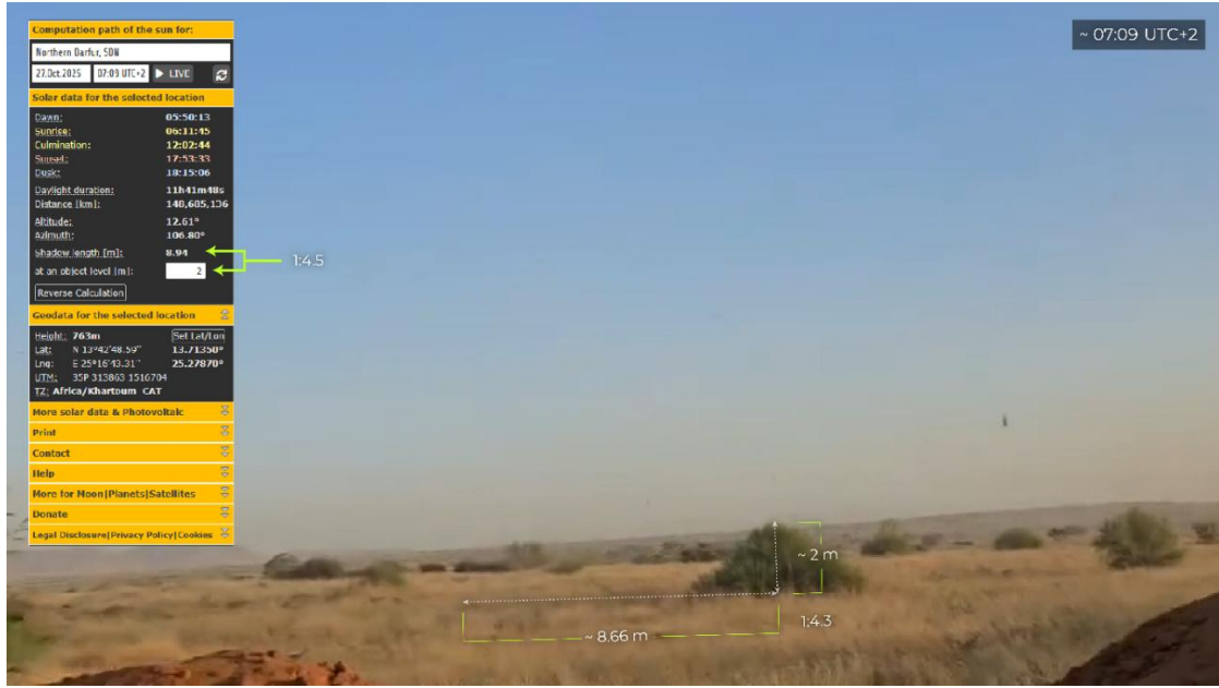
الشكل ١٩: مقارنة نسبة طول الظل إلى ارتفاع الشجرة مع نتائج برنامج SunCalc في الموقع نفسه، مما ينتج عنه وقت تقريبي ٩:٠٧ صباحاً بالتوقيت المحلي [13.713530, 25.278752]. المصدر: فيسبوك، SunCalc
